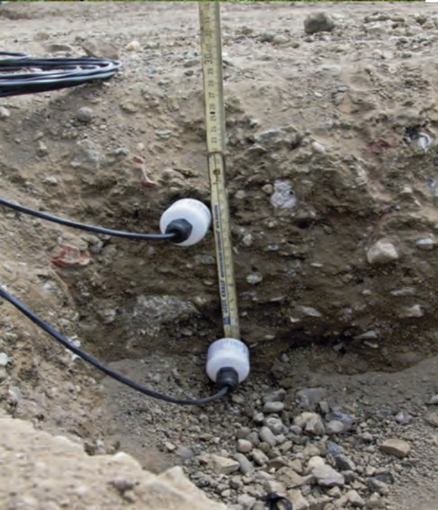
Bodenprofil Hafengelände Neuss mit Messensoren für Bodenfeuchte/ -temperatur
